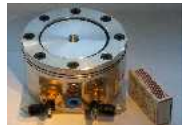
Bild 3: pneumatischer Dämpfer montiert
