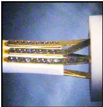
Abb. 1: Kovar-Band (0,8 x 0,1 mm) auf Au-PAD geschweißt
