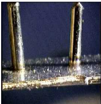
Abb. 2: Edelstahlstifte (Ø = 100 µm) mit Edelstahlfolie (d = 50 µm) verschweißt
