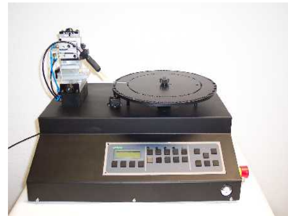
Nr. 13: Randlackiergerät für optische Mikrolinsen
