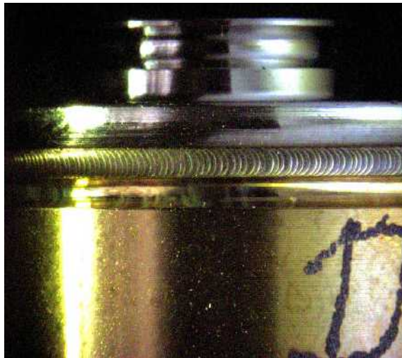
Nr. 10: Edelstahlgehäuse mit Laser geschweißt; Wandstärke = 1,2 mm
